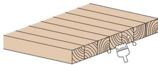
塗装品をカットして使用する場合はカット面も必ず塗装して下さい。
