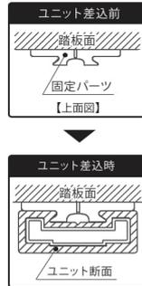
②ユニットの垂直、水平を確認し、固定柱側の座金をビス止め、中央可動部を仮打ちする。※この時点では、可動柱側の座金にビス止めはしないでください。
