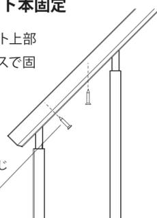
②可動柱も水平、垂直を調整してから踏板上にビスで固定する。仮打ちしていた中央部のビスも増し締める。
