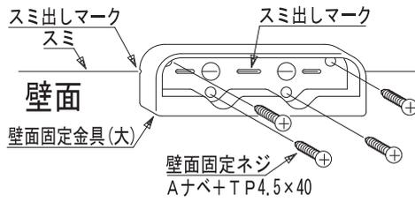
壁面にスマシ後、壁面固定金具(大)をスマシマークに合わせ、壁面固定ネジAナベ+TP4.5×40 4本にて固定します。
