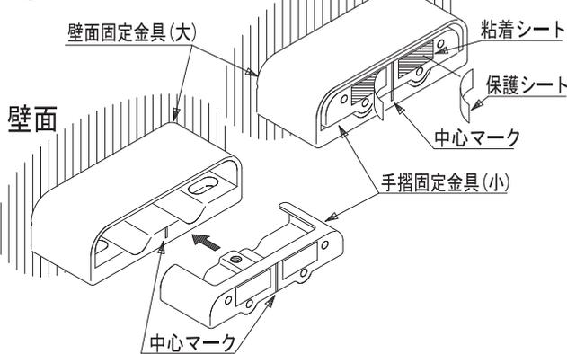
手摺固定金具(小)を壁面固定金具(大)に差し込みます。(金具各々の中心マークに合わせながら差し込んでください)手摺固定金具(小)の粘着シートの保護シートをはがし、手摺仮固定の準備をします。
