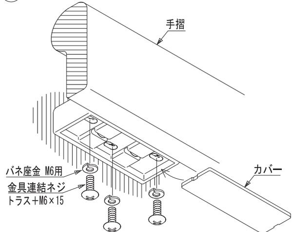
手摺固定金具(小)に固定した手摺を、壁面に固定した壁面固定金具(大)に差し込み、金具連結ネジセット(トラス+M6×15 3本/パネ座金M6用 3個)にて固定し、カバーを装着します。
