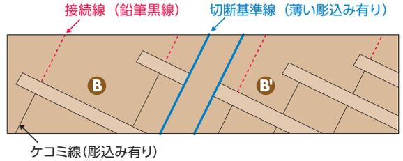
施工の際は、実際に取り付ける前に仮止めをして、必ず接統位置の確認をしてください。
