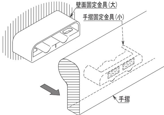
手摺と手摺固定金具(小)が粘着シートで仮固定されたことを確認した後、手摺を手前に引き抜きます。
