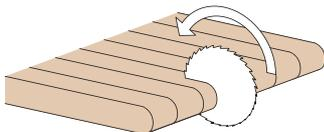
カットは必ず塗装面から、丸ノコを使用する場合はR面からダウンカットで行って下さい。
