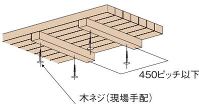
カウンターは450mm以下のピッチで補強材(現場配布)をとりつけて下さい。
