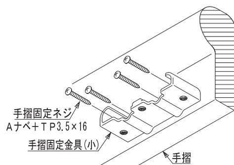
手摺に仮固定された手摺固定金具(小)を手摺固定ネジAナベ+TP3.5×40 4本にて固定します。
