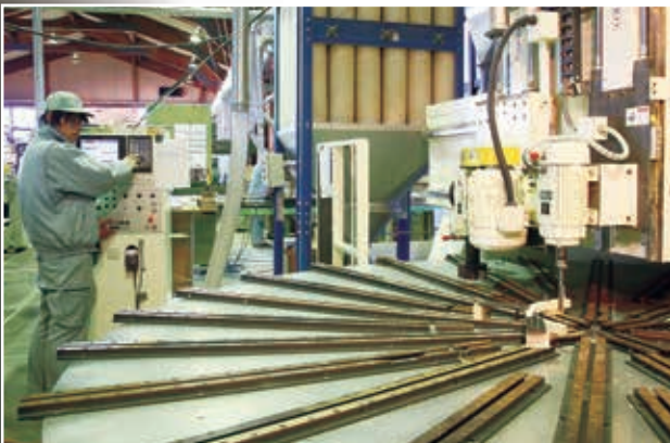
▲NCアール製造機
